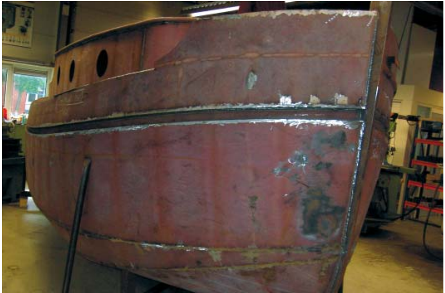
Een stalen sloep in aanbouw
