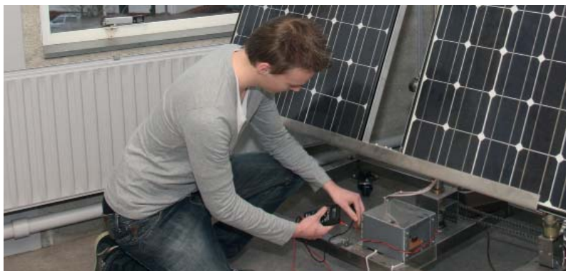
Proefopstelling zonnevolgsysteem. Zonnepanelen volgen de stand van de zon.
