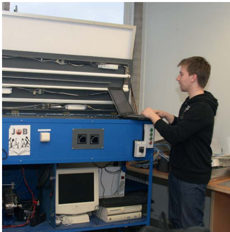
Proefopstelling Energie kast. Toepassing verschillende efficiënte TL verlichtingen met gebruikmaking van onder andere zonnepanelen en accu's.
