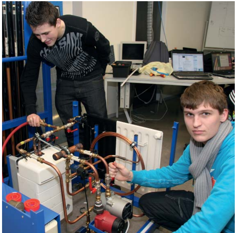
Proefopstelling Heat pipes. Zonne-energie wordt omgezet in warmte en opgeslagen in een boiler.
